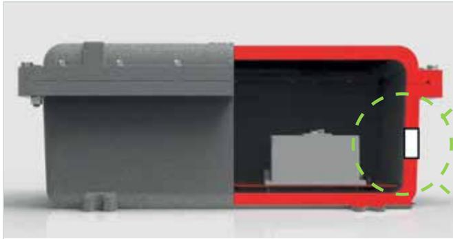
Los accesorios de instalación, que garantizan un grado de protección contra el ingreso (IP) definido mediante una arandela elástica, deben ajustar hasta que el ala del mismo haga tope con la arandela y ésta con la pared de la caja, por lo tanto el eje del orificio debe ser perpendicular a esa pared.
